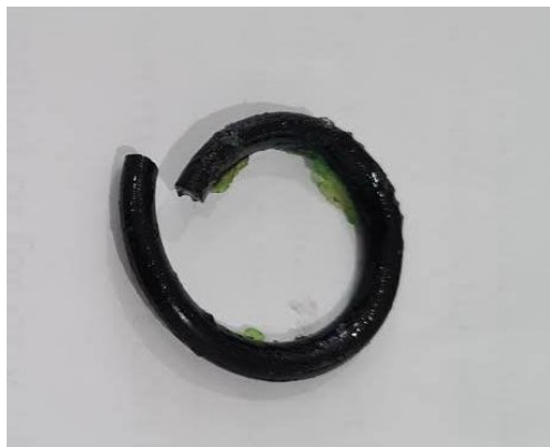
Gambar 1 kerusakan seal pada sambungan regulator
